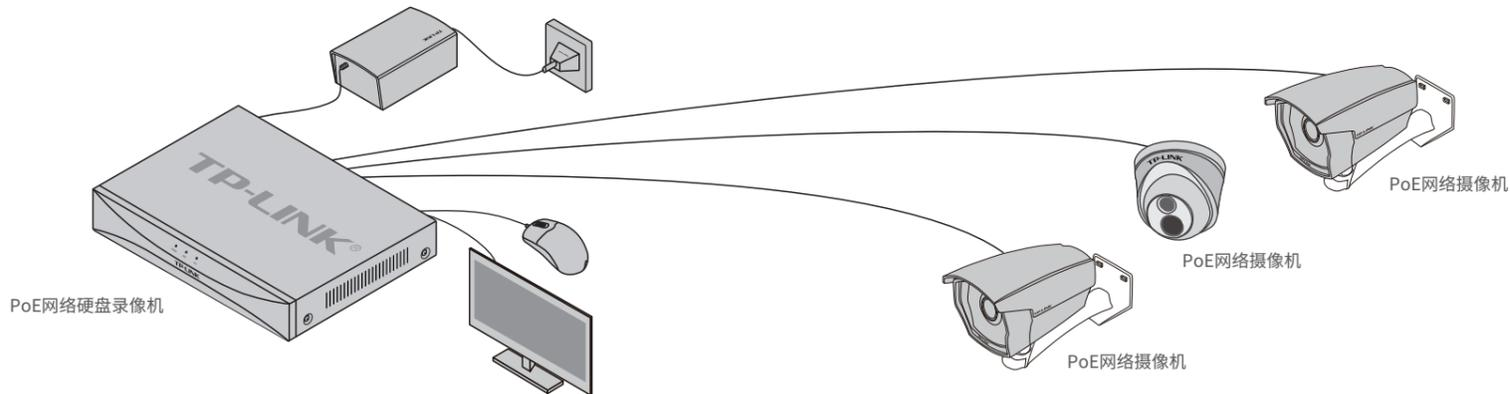
NVR连接显示器时，可以通过NVR的本地GUI界面进行管理。
